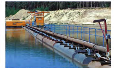
IN PYRAS GEWINNT ein Saugbagger derzeit den Löwenanteil des Materials aus dem nassen Element.
