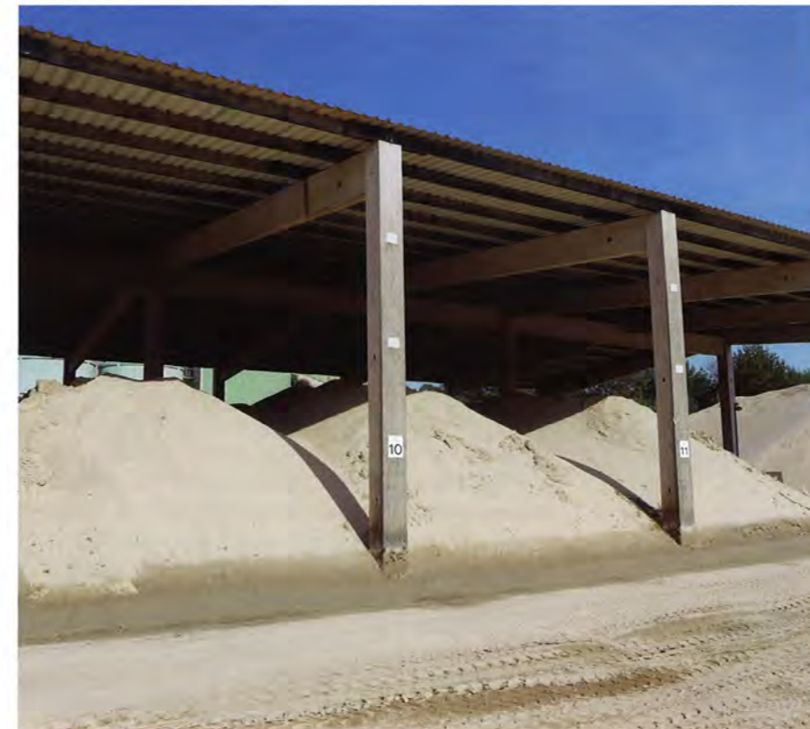
GELAGERT WERDEN DIE FERTIGPRODUKTE überdacht, aber offen. Damit wird eine Wiederbefeuchtung der Sande durch Regen- oder Kondenswasser vermieden.
